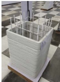
Figura 34 - Forma de concreto da Yingchuang. Fonte: WU et al. (2016)
